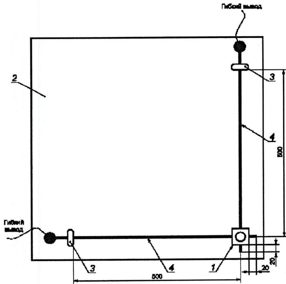
1 — соединительный компонент для перекрестного соединения; 2 — основание из изолирующего материала.
