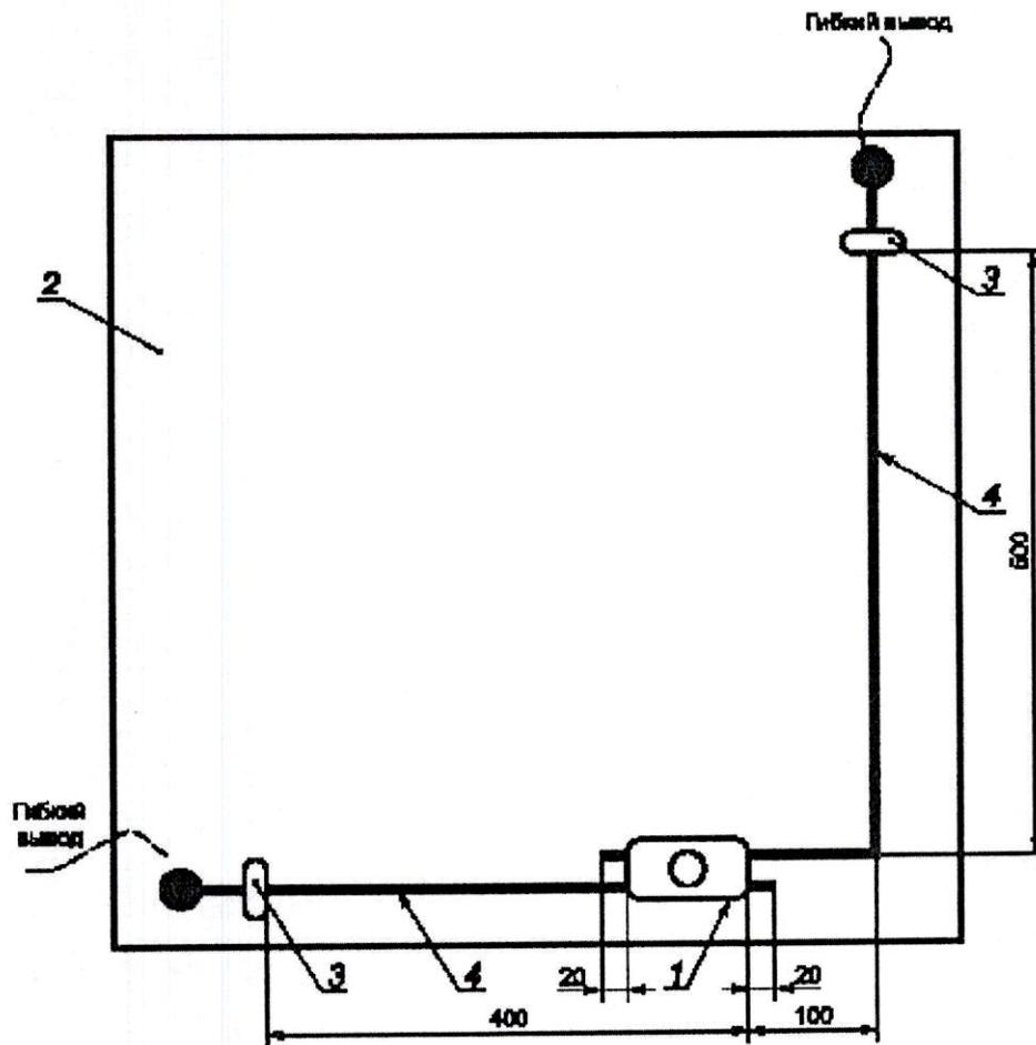
1 — соединительный компонент для параллельного соединения; 2 — основание из изолирующего материала;
